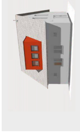
Abb.: Flachdachgaube V2
