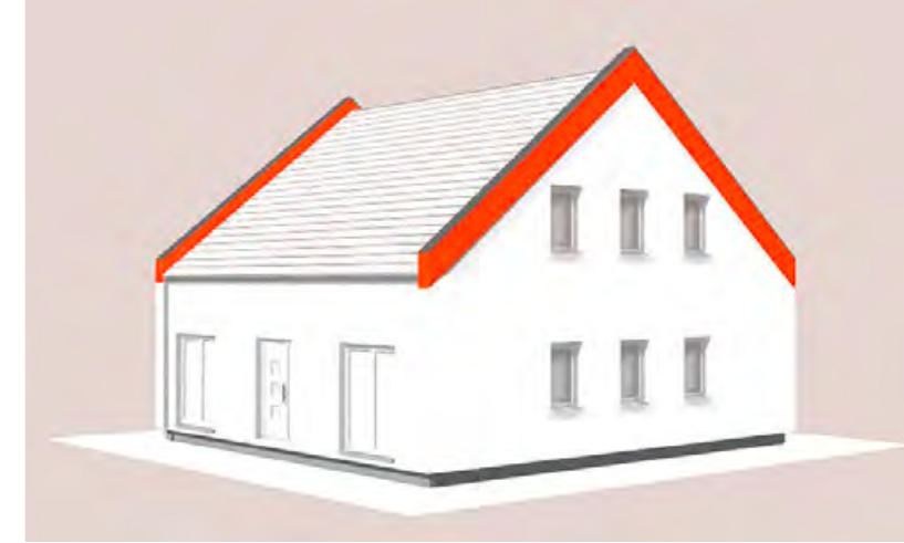
Abb.: Haus mit erhöhter Giebelwand
