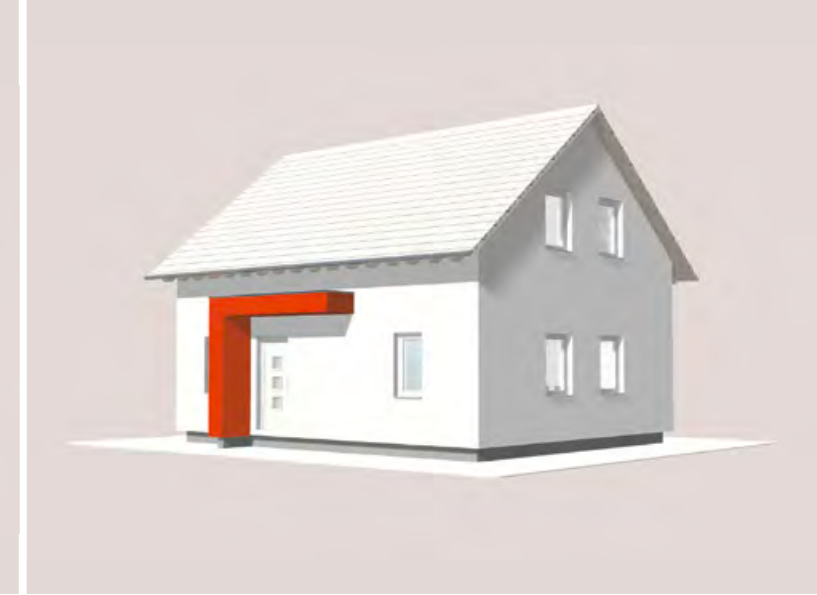
Abb.: Eingangsüberdachung mit Flachdach und einer Wandscheibe
