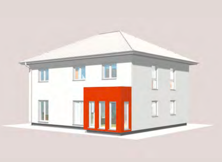
Abb.: Rechteckerker mit nicht begehbarem Flachdach
