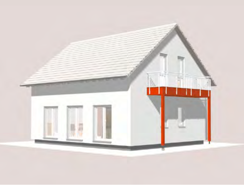
Abb.: Balkon auf Holzstützen
