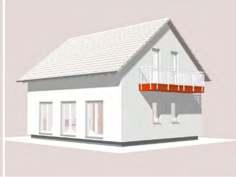
Abb.: Freitragender Balkon
