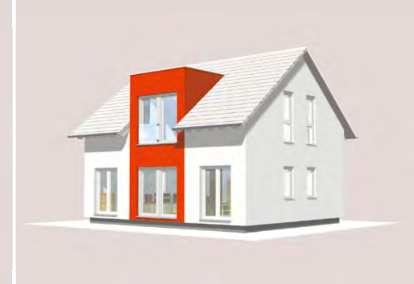
Abb.: Fassadengleiches Zwerchhaus mit Flachdach
