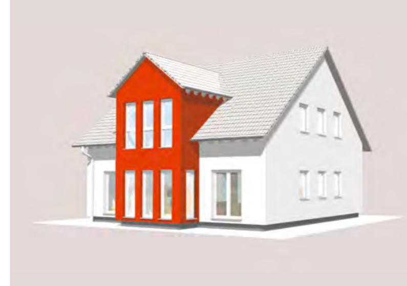
Abb.: Vorgezogenes Zwerchhaus mit Satteldach
