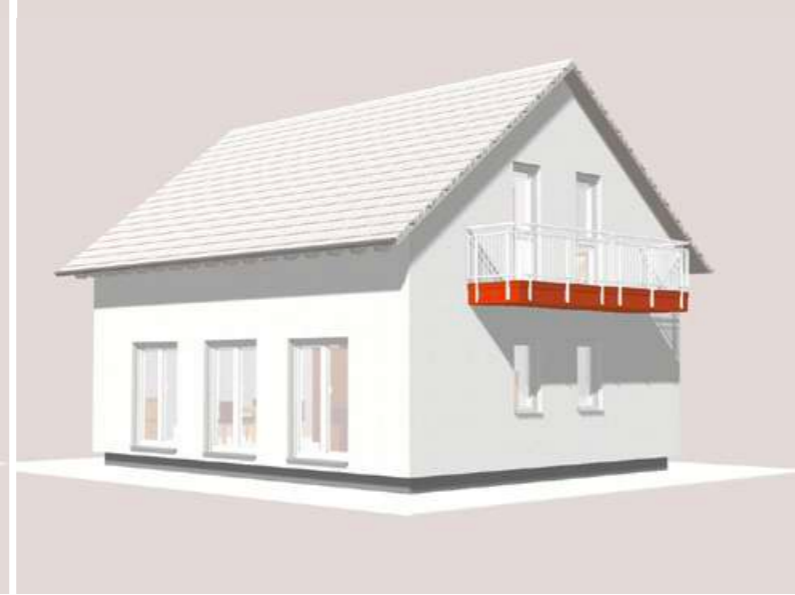
Abb.: Freitragender Balkon
