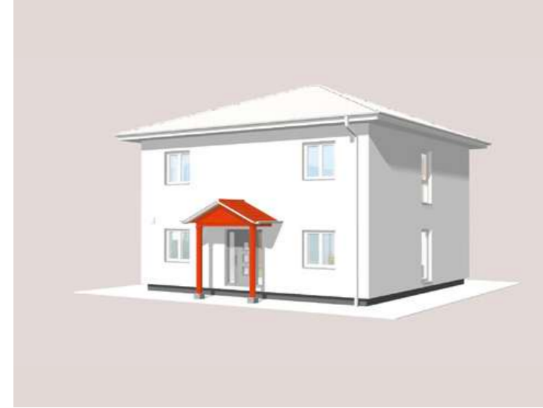
Abb.: Eingangsdach mit Giebel und verzinkten Stahlstützen
