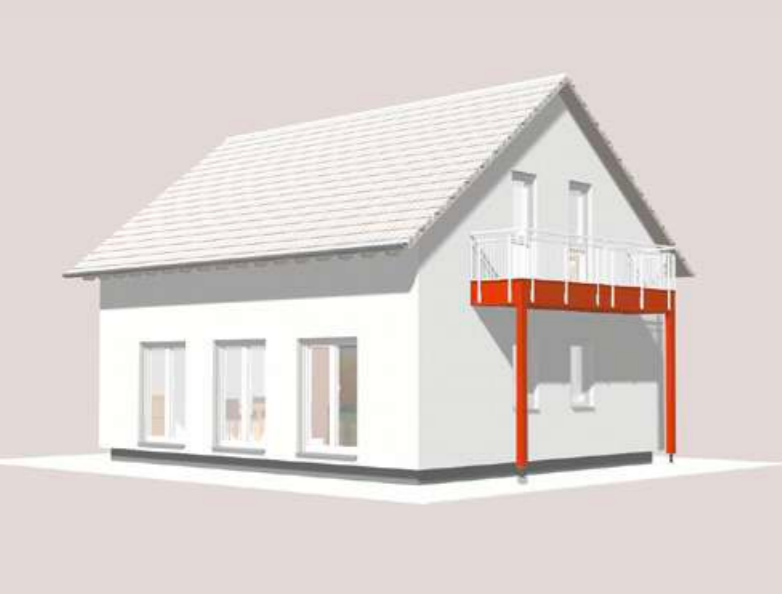
Abb.: Balkon auf Holzstützen
