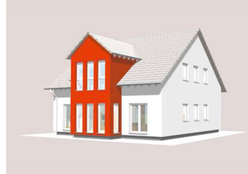
Abb.: Vorgezogenes Zwerchhaus mit Satteldach
