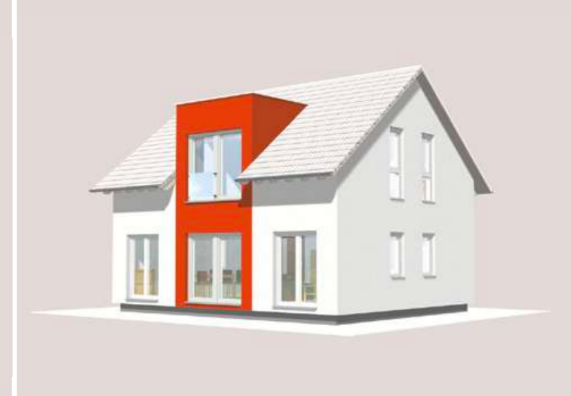
Abb.: Fassadengleiches Zwerchhaus mit Flachdach
