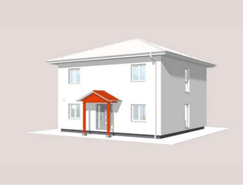
Abb.: Eingangsdach mit Giebel und verzinkten Stahlstützen
