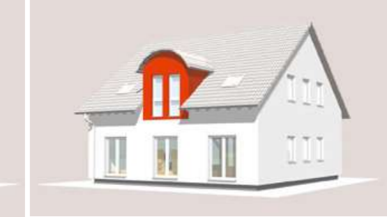
Abb.: Fassadengleiches Zwerchhaus mit Tonnendach
