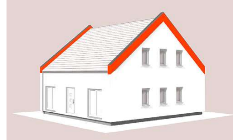
Abb.: Haus mit erhöhter Giebelwand
