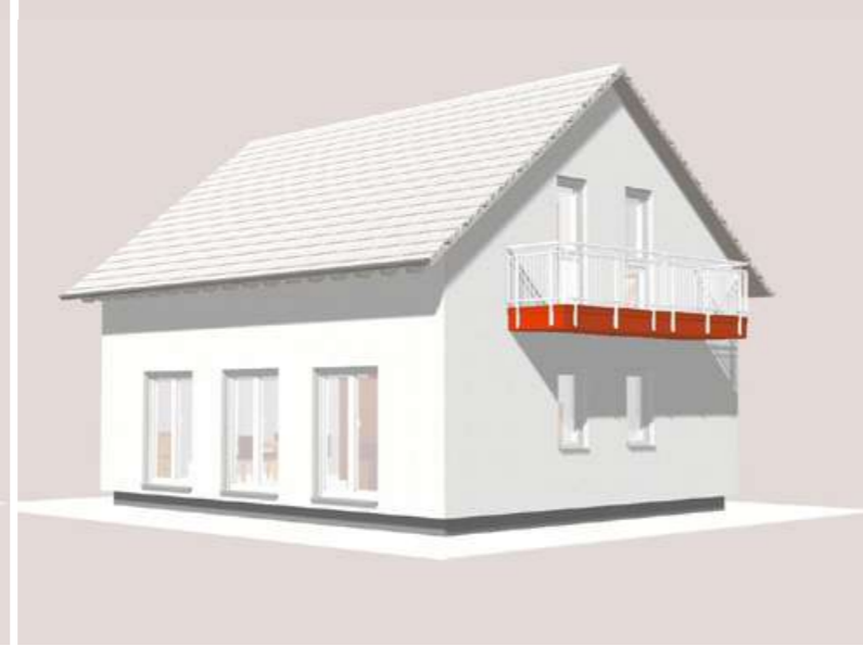
Abb.: Freitragender Balkon
