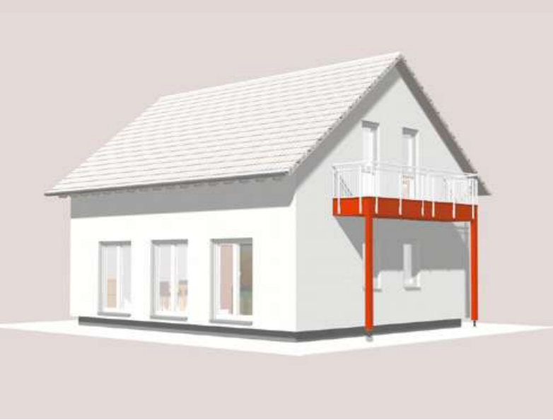
Abb.: Balkon auf Holzstützen
