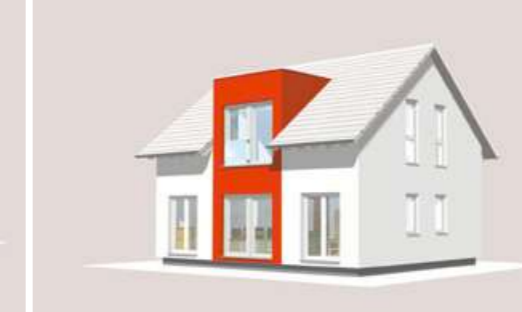
Abb.: Fassadengleiches Zwerchhaus mit Flachdach
