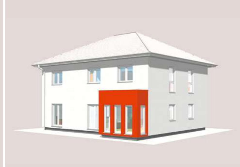
Abb.: Rechteckerker mit nicht begehbarem Flachdach
