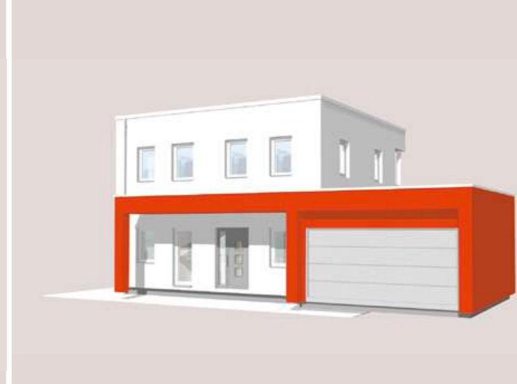
Abb.: Doppelgarage mit Hauseingangsüberdachung
