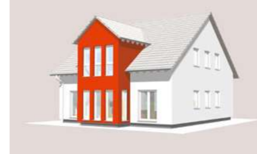
Abb.: Vorgezogenes Zwerchhaus mit Satteldach
